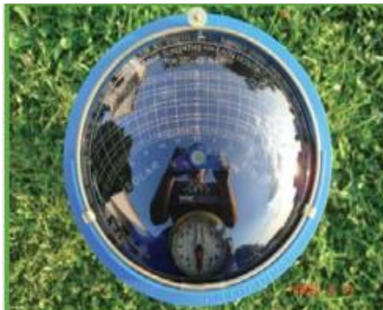
Εικόνα 3: Φακός στο Solar Pathfinder που Χρησιμοποιείται για τον Προσδιορισμό των Μετρήσεων Σκίασης
